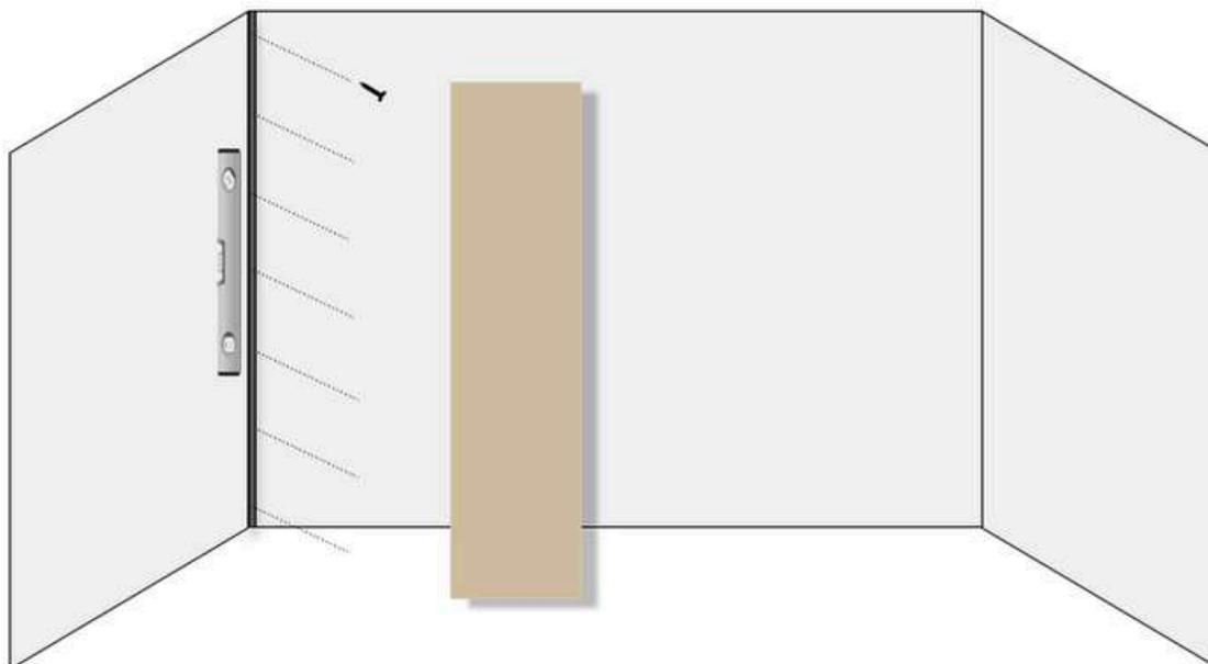
Pour le démarrage d'une installation de panneaux muraux de mur à mur, commencer par la pose du profil de démarrage en C.
