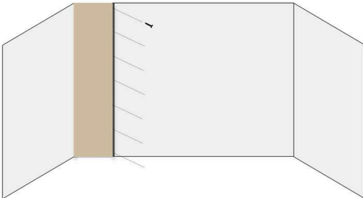
Insérer le profil de fixation en H dans le panneau et le fixer à l'aide de vis adaptées.
