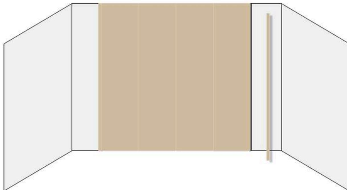
Terminer l'installation des panneaux avec la pose d'un tasseau de finition sur le dernier profil en H.
