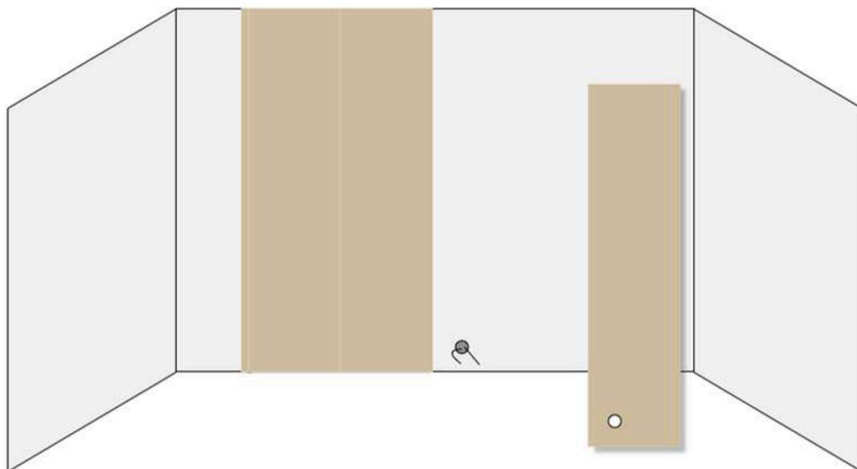
Après avoir coupé le courant, démonter le cache et la prise pour permettre l'installation du panneau.
