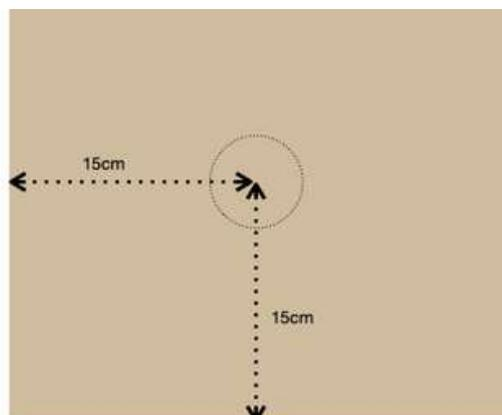
Repérer le positionnement de la prise sur le mur et percer le panneau à l'aide d'une scie cloche diamètre 68mm.
