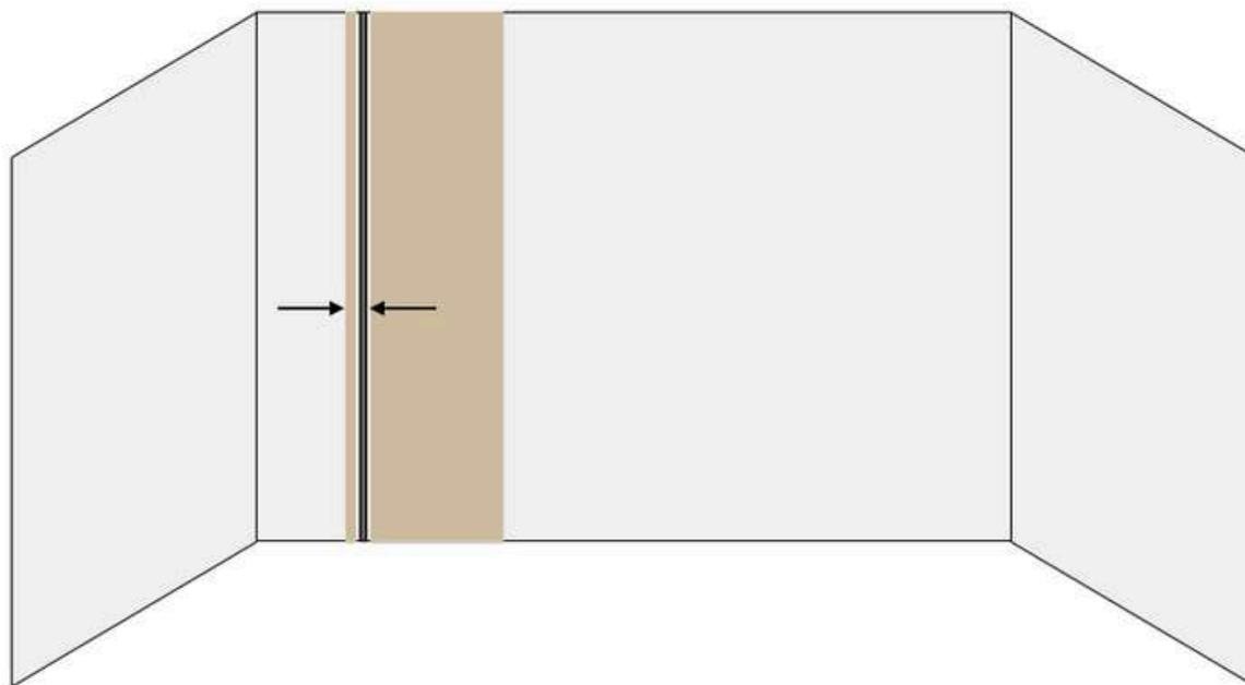
Insérer le panneau mural et le tasseau de finition dans le profil de démarrage en H.
