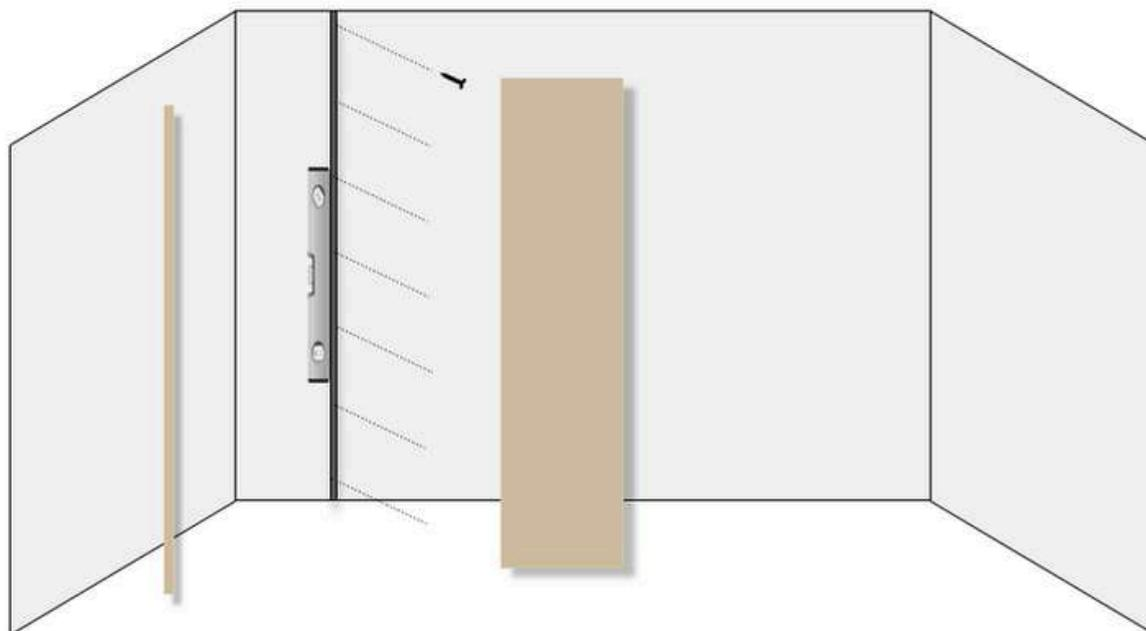
Pour le démarrage d'une installation de panneaux muraux de mur à mur, commencer par la pose du profil de fixation en H.
