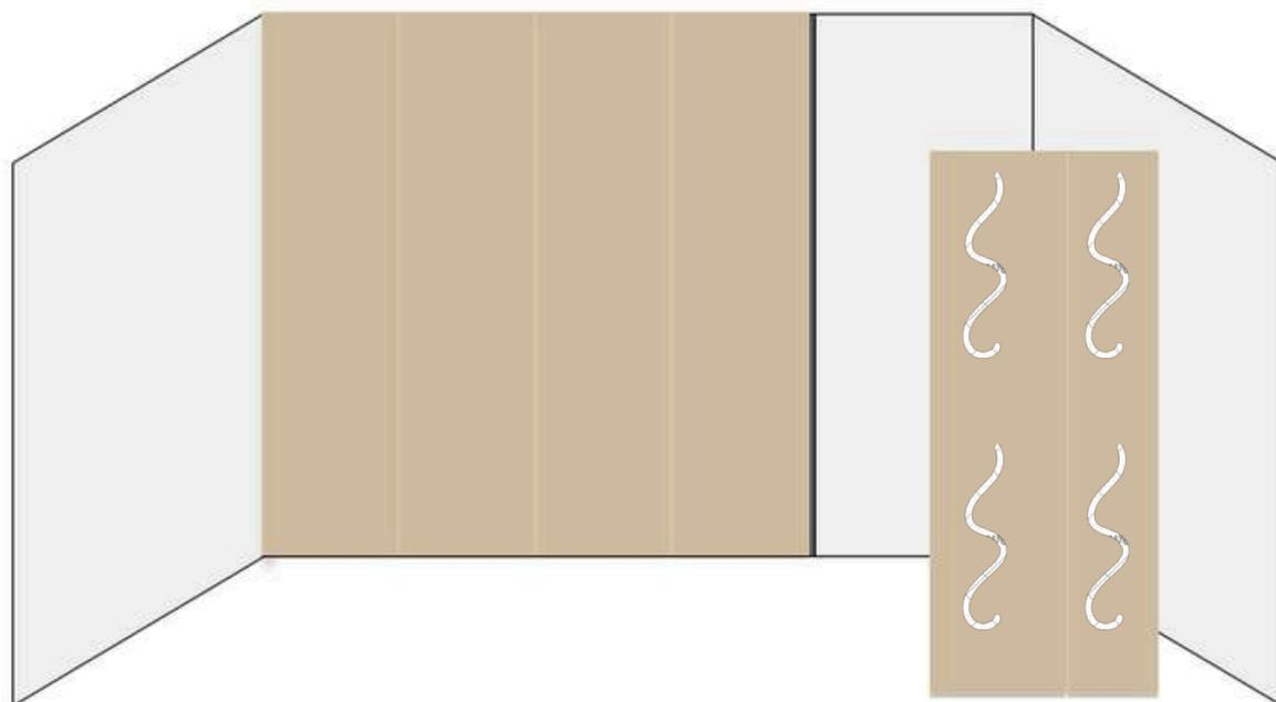
Coller les deux derniers panneaux, eux-mêmes assemblés avec le profil de fixation en H.
